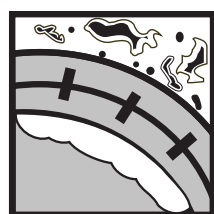
Malla metálica y mortero proyectado
